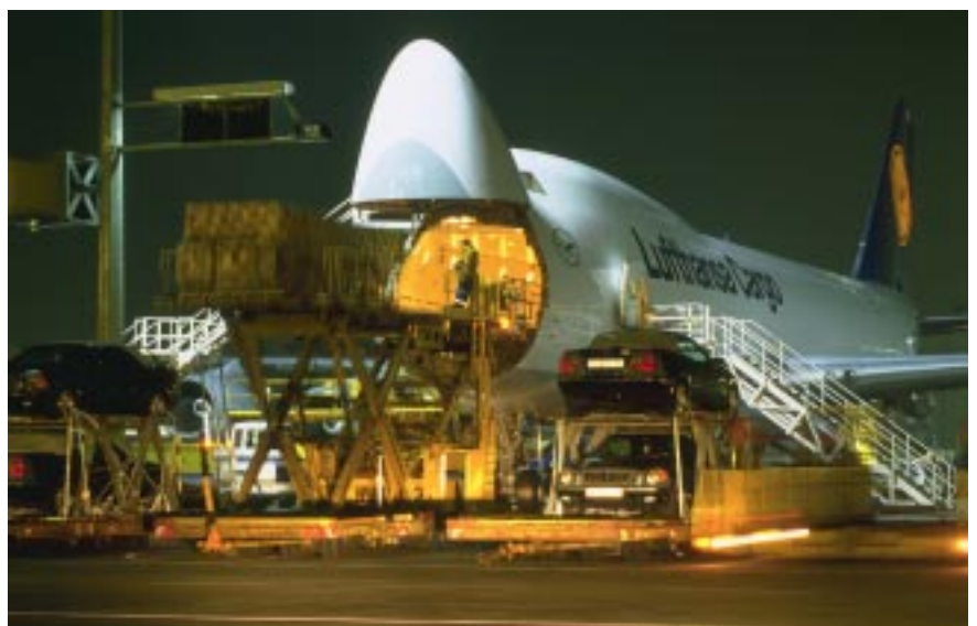
Eine Boeing 747-200 F kann gleichzeitig durch die hochklappbare Nase und durch eine seitliche Frachttür im Rumpfheck beladen werden. Foto: Werner Krüger / Lufthansa
