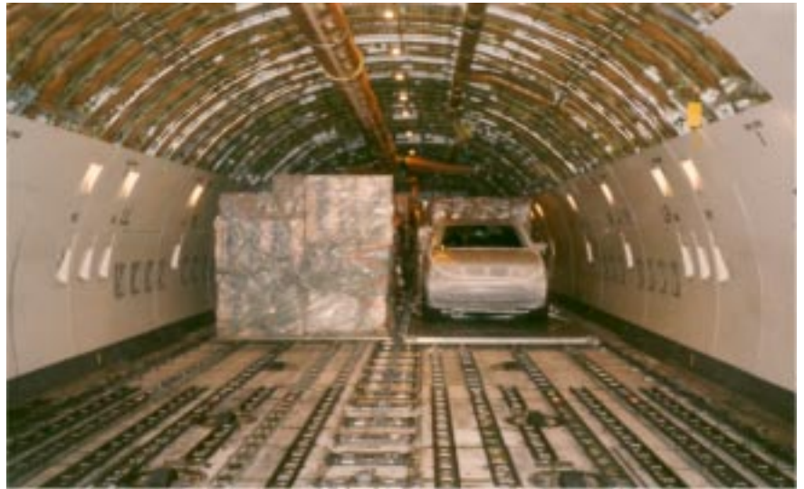
Verstaute Fracht innerhalb eines Boeing 747-200F Frachters, die auf speziellen Paletten in den Boden des Hauptdecks regelrecht eingeklinkt worden ist.
